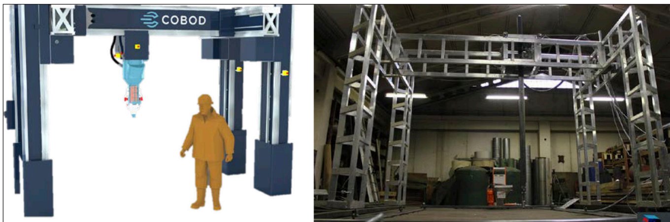
9. ábra: COBOD (bal) és Betabram (jobb) betonnyomtatók (COBOD, 2020; Betabram, 2020)
