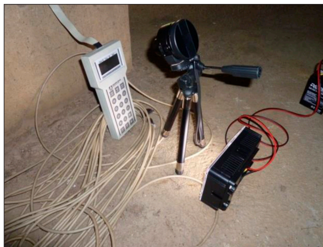
5. ábra: Saru reakcióerő-változás mérése a Nagyrákosi völgyhídon
