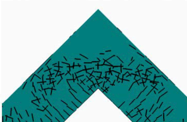
12. ábra: Repedésképek – felül: laboratóriumi kísérlet (Morgan, 2000), alul: numerikus kísérleti eredmények
