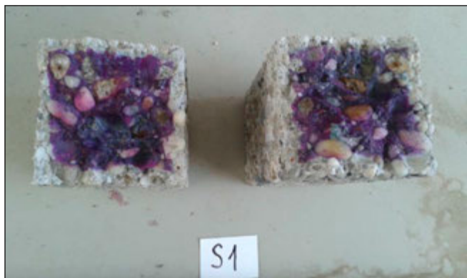
12. ábra: Az F&T beton fenolftaleines vizsgálata
