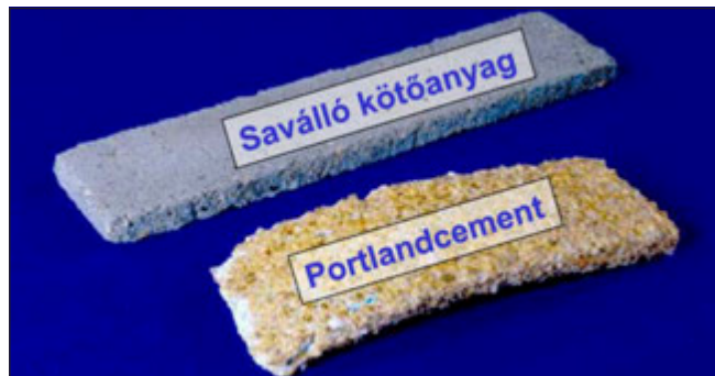
8. ábra: Kénsavban áztatott próbatestek roncsolódása 75 napos tárolás után: alul egy tiszta szulfátálló portlandcementből készült, felül pedig cementet, pernyét és mikroszilikát is tartalmazó 10x40x160mm-es habarcslemez látható. (Hüttl - Hillemeier, 2000)
