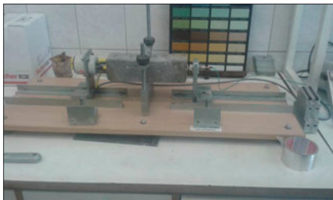
13. ábra: 70x70x250 mm-es próbatest önrezgésszámának mérése. ÉMI
