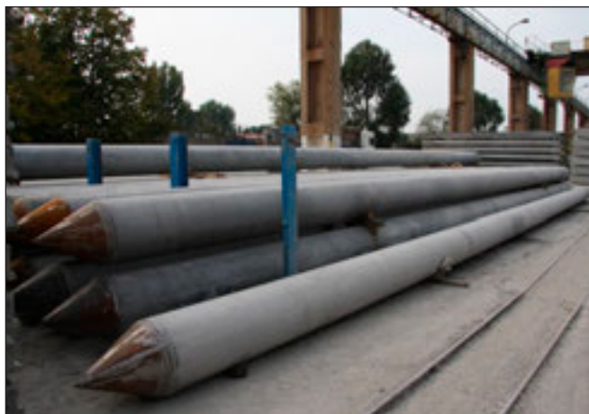
7. ábra: Pörgetett technológiával készült 18,0 m hosszúcölöp
