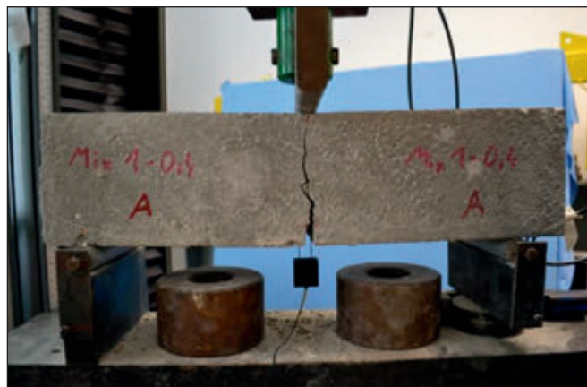
4. ábra: Három pontos hajlító-húzószilárdság vizsgálat CMOD vezérelten
