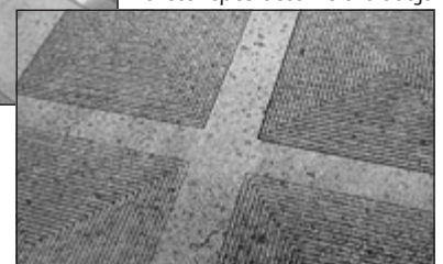
A DysCrete-napelem vezetőképés beton elektródája
