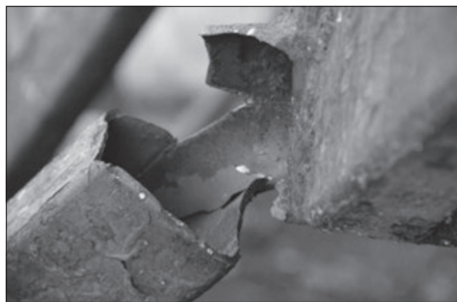
16. ábra: Részben a hegesztési varrat, részben az acél anyagának tönkremenetele (Testnevelési Egyetem tüzesete, 2015. okt. 15.)
