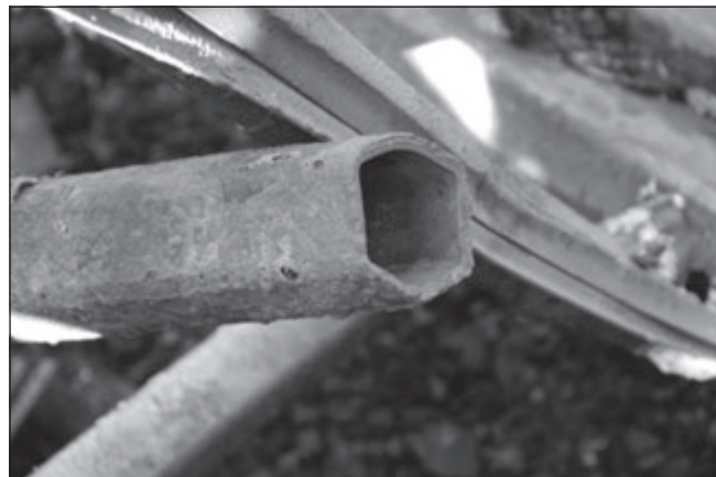
15. ábra: A hegesztési varrat tönkremenetele (Testnevelési Egyetem tüzesete, 2015. okt. 15.)
