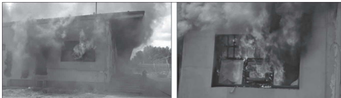
7. ábra: Az üveg kitörése és megfolyása a tűz hatására
