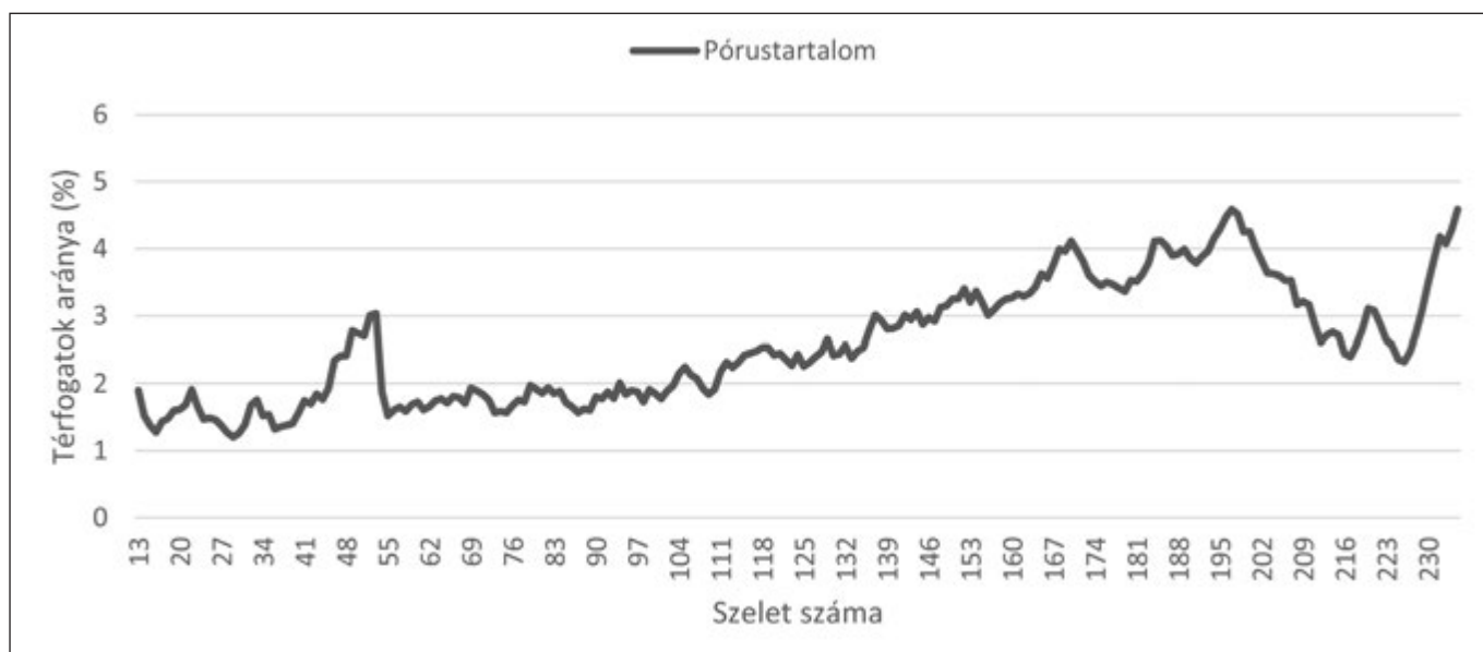
6. ábra: A pórusok eloszlása az egyes szeleteken belül (5. c. ábra felnagyított képe)
