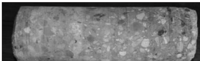
3. ábra: A tűzkárosult szerkezetből vett magminta (fénykép, Balázs Lublóy, Földes, 2015)
