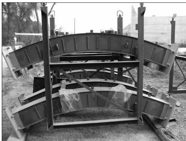
7. ábra: Nyeregyszerkezet a ferde kábelek átvezetésére
