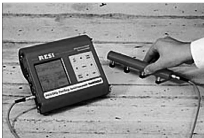
3. ábra: A RESI típusú, Wenner elrendezésű ellenállásmérő
