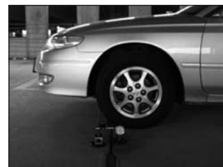
19.a,b ábrák: Parkoló épület, Holyoke, Mass. Túlzott deformáció (lehajlás)
