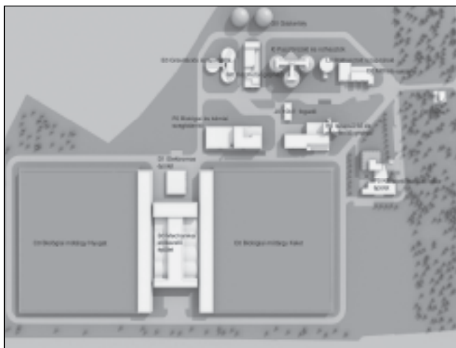
4. ábra: BKSZT tömbvázlata és az építmények elrendezése
