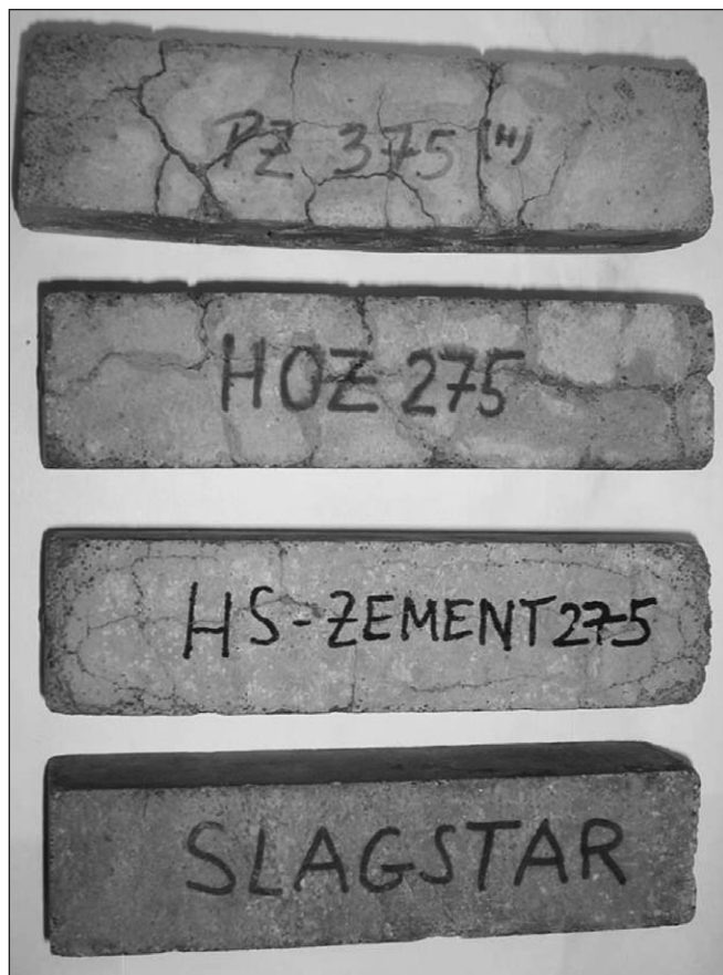
1. ábra: Slagstar® és 3 másik cementfajta összehasonlítása 5 éves szulfátoldatos tárolás után (fentről lefelé: CEM II/A 15% kohósalak-tartalommal, CEM III/A 45% kohósalak-tartalommal, CEM I 32,5 C 3 A-mentes és Slagstar®)
