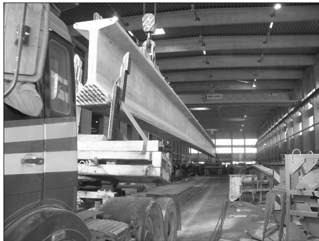
7. ábra: Az FI-150 gerenda kiszállítása a gyártócsarnokból
