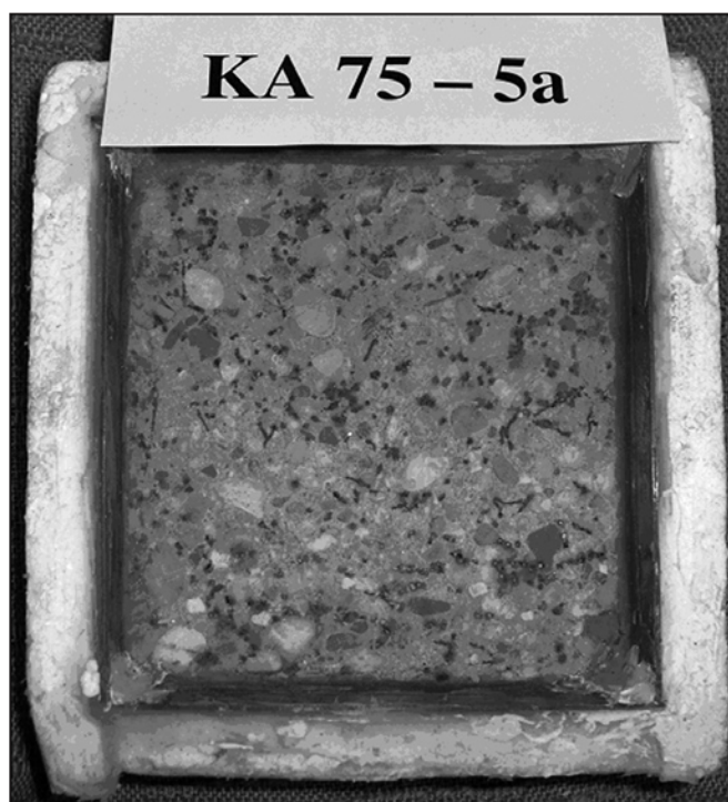
7. fénykép. Hőszigetelt, peremezett, hámlasztott próbatest
