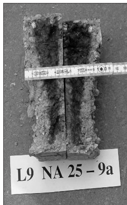
2. fénykép. L9 jelű hámlasztott próbatest (lásd 11. ábra) (megjegyzés: a középső, sötétebb tónusú tartományok fenolftalein pozitívák)
