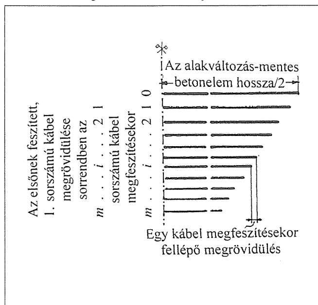
3. ábra: A veszteség és az elvi feszítőerő sémája utófeszített tartónál
