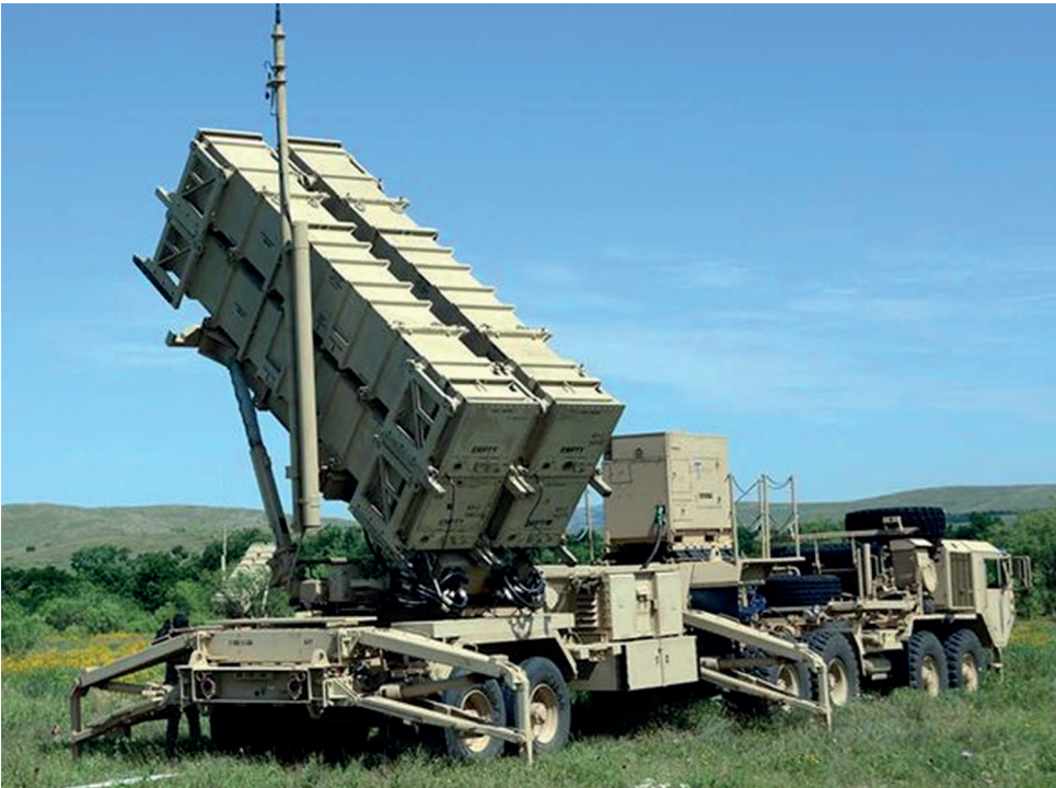
13. ábra Patriot M901/902/903 indítóállvány 4 db MIM-104E/D rakétával [103]
