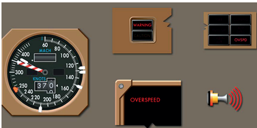
11. ábra „Overspeed” felirat az EICAS-kijelzőn [16]
