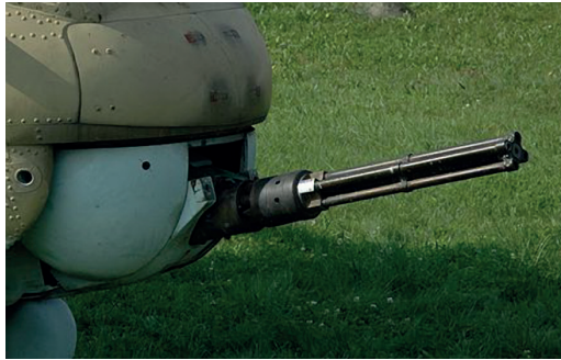
9. ábra A JakB-12,7 géppuska [18]
