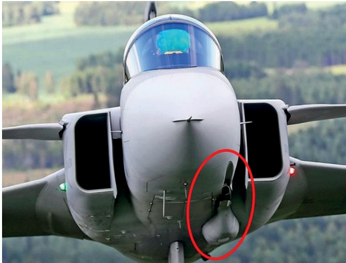
5. ábra Mauser BK-27 gépágyú elhelyezkedése a JAS-39-en [14]
