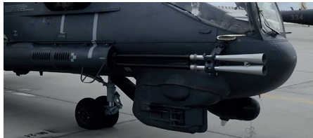
10. ábra A GS-2-30 gépágyú [19]
