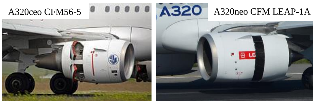
9. ábra Kibillenő ajtós (CFM56-5B) és hátrasikló burkolatos (CFM LEAP-1A) sugárfékek ([20] és [21])
