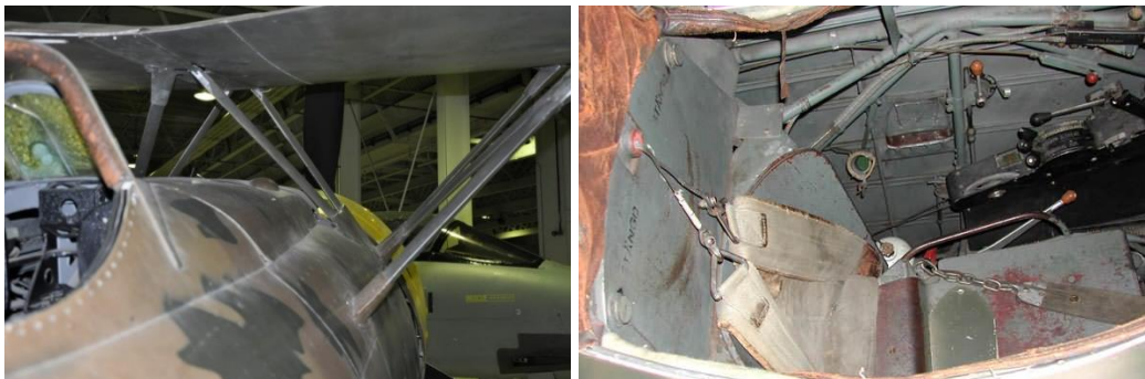
9. ábra A repülőgép pilótafülkéje egyszerű és ergonomikus. Az ülés magassága állítható. A jobb oldali felvételen a Svéd Királyi Légierő gyűjteményében megmaradt repülőgép kabinja látható
