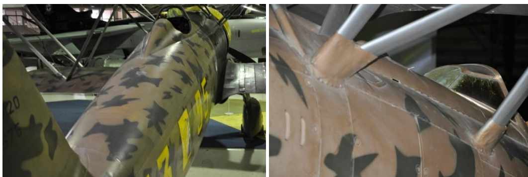
7. ábra A kabin kialakítása során törekedtek rá, hogy a nyitott építés ellenére a pilótát a lehető legjobban védjék az időjárás viszonyosságaitól
