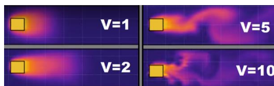
9. ábra A turbulencia kialakulása a sebesség függvényében 17 [24]
