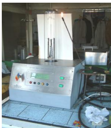
8. ábra LOI vizsgálat berendezései [23]
