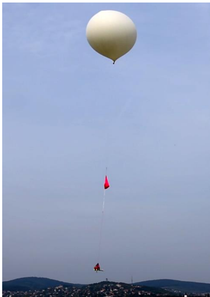
2. ábra Egy könnyű személyzet nélküli szabad ballon [4]
