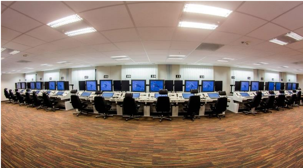
3. ábra Valós-idejű szimulátor a HungaroControlnál. A platform 34 irányítói és 27 álpilóta munkahelyből áll, fejlett ATM eszközökkel, SYSCO (rendszerek közötti koordináció) and Data-Link környezettel felszerelve
