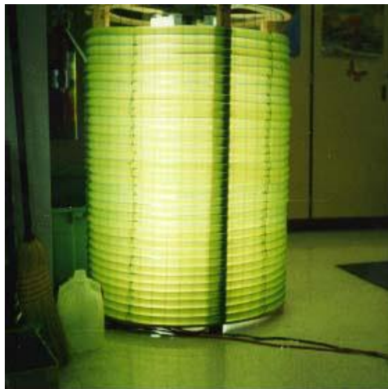
6. ábra Spirálisan feltekert csővezeték egy fotobioreaktorban [8]
