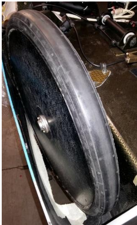
3. ábra Karbon kompozit felni (saját felvétel)
