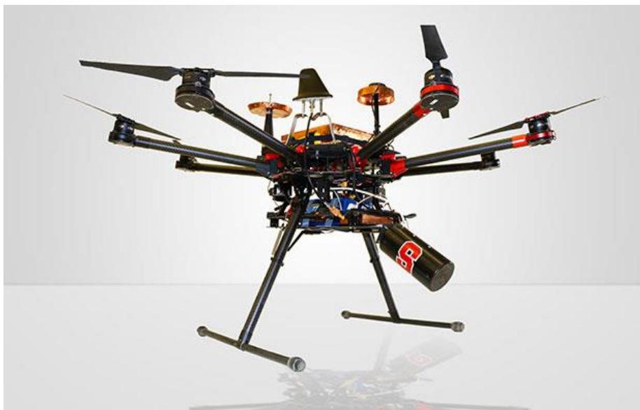
2. kép. GPS zavaró berendezést kereső oktokofter [6]
