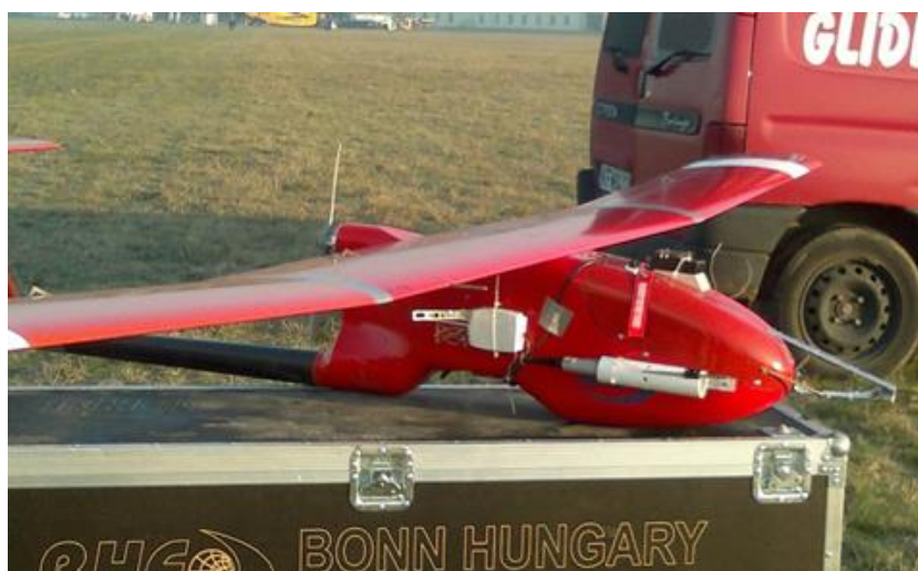
8. ábra Az UAS eszköz teljes szenzorrendszerrel felszerelve, a repülés előtti teszt alatt. A rádiószonda a gép oldalán látható, mint fehér „doboz” [5]
