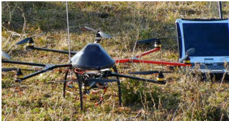
2. ábra Meteorológiai célra kialakított oktokofter, határréteg mérési feladatra [5]
