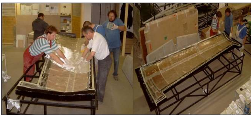
29. ábra Kompozit repülőgép sárkány építése nedves kézi impregnálással 33
