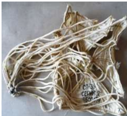
4. ábra SzP-36 típusú stabilizáló ejtőernyő 43 (A képen jól megfigyelhető a máltai kereszt-kialakítás, és a középszínórok alkalmazása.)
