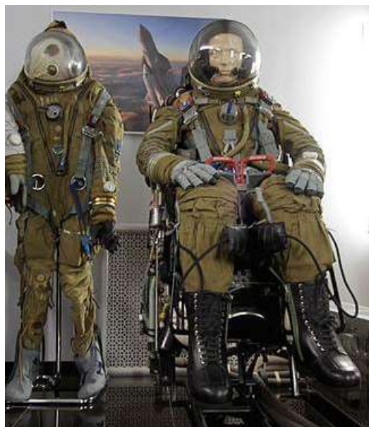
8. ábra IPSz-72 típusú hevederzet egy K-36 típusú katapultülésben ülő, „Sarlósfehérkék” szkafoandert viselő bábún, egy moszkvai kiállításon 51
