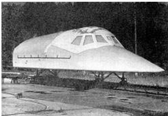
11. ábra A földi katapultpróbákat végrehajtó rakétaszán, amely a Buran pilótafülkéje alakját formázza 56
