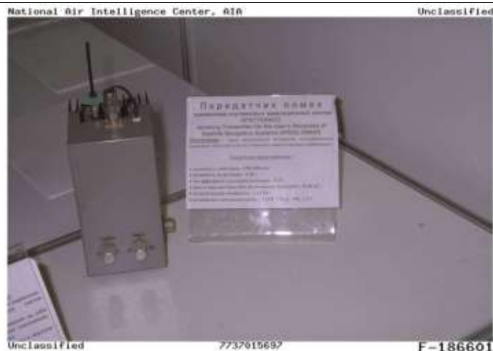
5. ábra. Egy korai orosz gyártmányú GPS/GLONASS zavaró berendezés [8]
