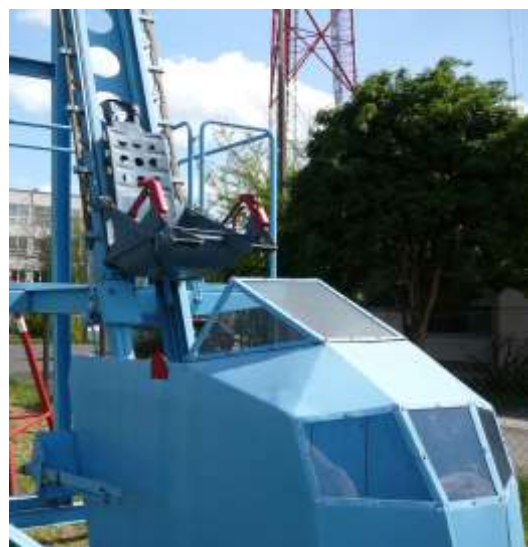
12. ábra Az NKTL-3 típusjelzésű gyakorló katapult-berendezés a MH HIM kezelésében lévő Szolnoki Repüléstörténeti Múzeumban. 50
