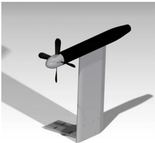
8. ábra A szélcsatornás vizsgálatokhoz alkalmazott kísérleti berendezés 3D-s modellje [11]
