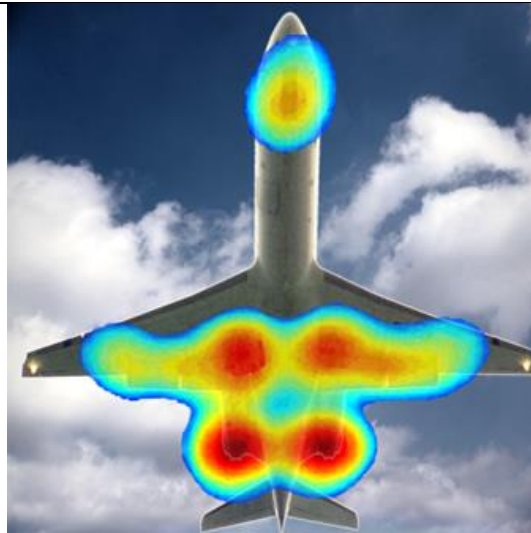
1. ábra A zajforrások egy fel/leszálló repülőgépnél 3
