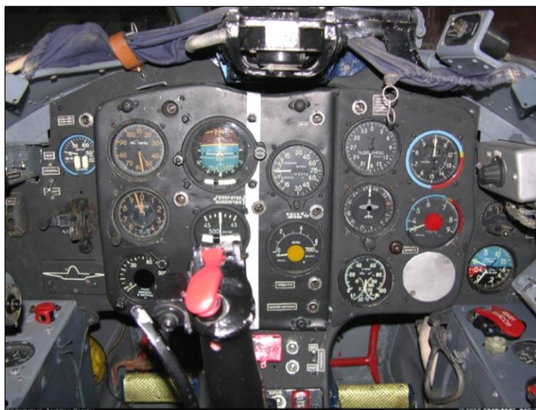
14. ábra A MiG-15UTI első fülkéjének mellső műszerfala 28 .
