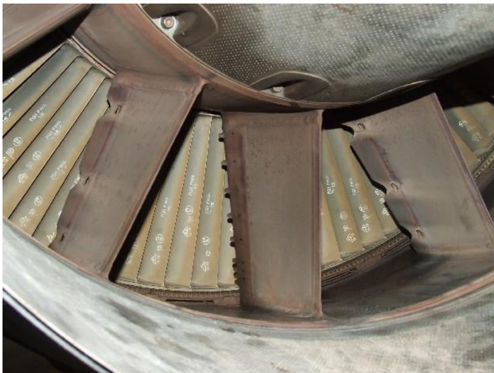
3. ábra Az IAE V2500 hajtómű turbina utáni nyomásának mérése
