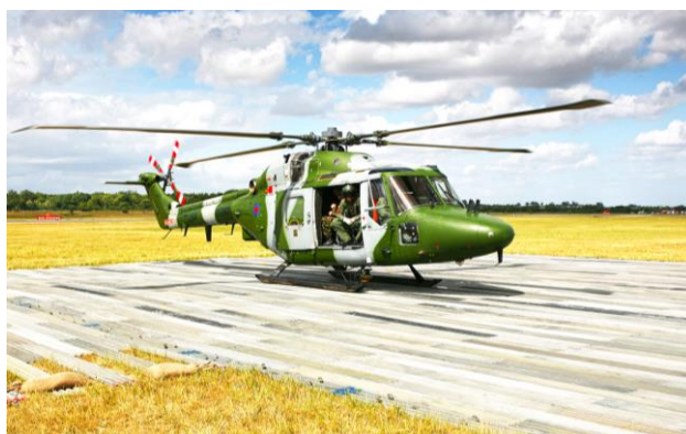
23. ábra A PSA panelekből elkészült le- és felszállóhely 48
