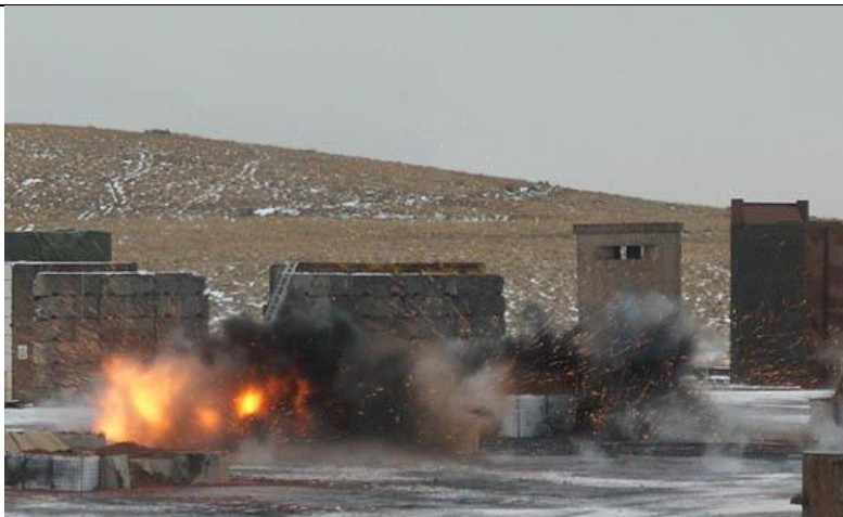
5. ábra A MAC® gabion elemek tesztelése robbantásra [5]
