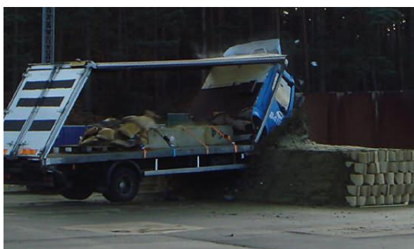
4. ábra DEFENCELL elemek tesztelése járművekkel [5]
