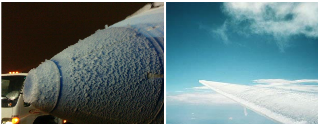
2. ábra A zúzmarás jegesedés tipikus megjelenési formái 4
