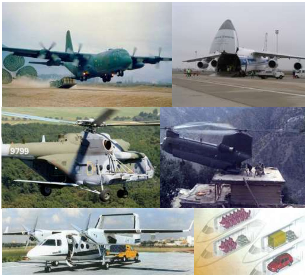
8. ábra C-130, An-124, Mi-171, CH-47, Szu-80 rárampa megoldásai [1]
