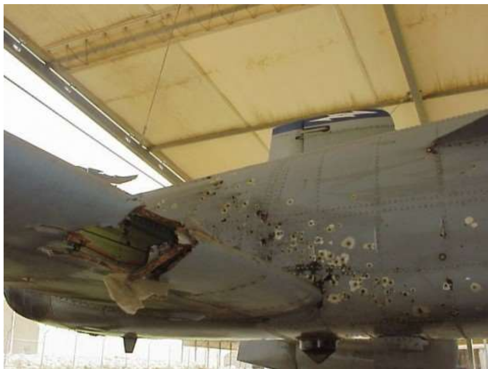
5.ábra. Bevetésben sérült A-10 Thunderbolt repülőgép [6]
