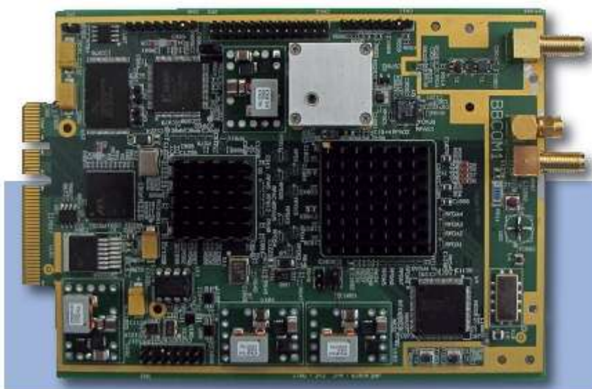
15. ábra A kommunikációs jelfeldolgozó kártya (BBCOM) fényképe
