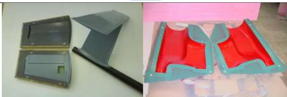
11. ábra A farokrész a sablonjával, ill. a törzs sablonja
