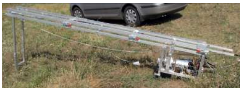
3. ábra Az elektromotoros katapult fényképe
