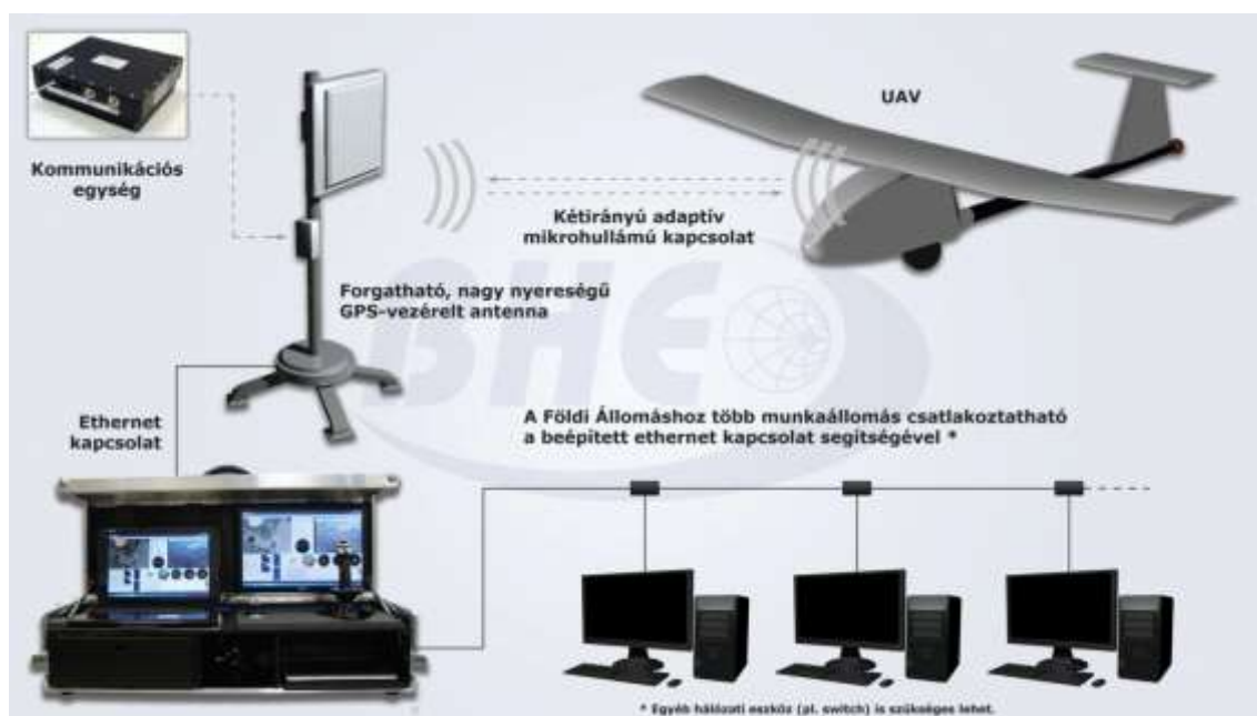
1. ábra Az UAV rendszer funkcionális felépítése
