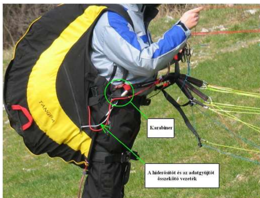
19. ábra Repülés közbeni mérésre előkészített mérőrendszer
