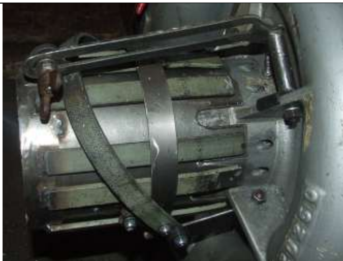
3. ábra A Ganz kompresszor házán kialakított pompázsgátló rendszer
