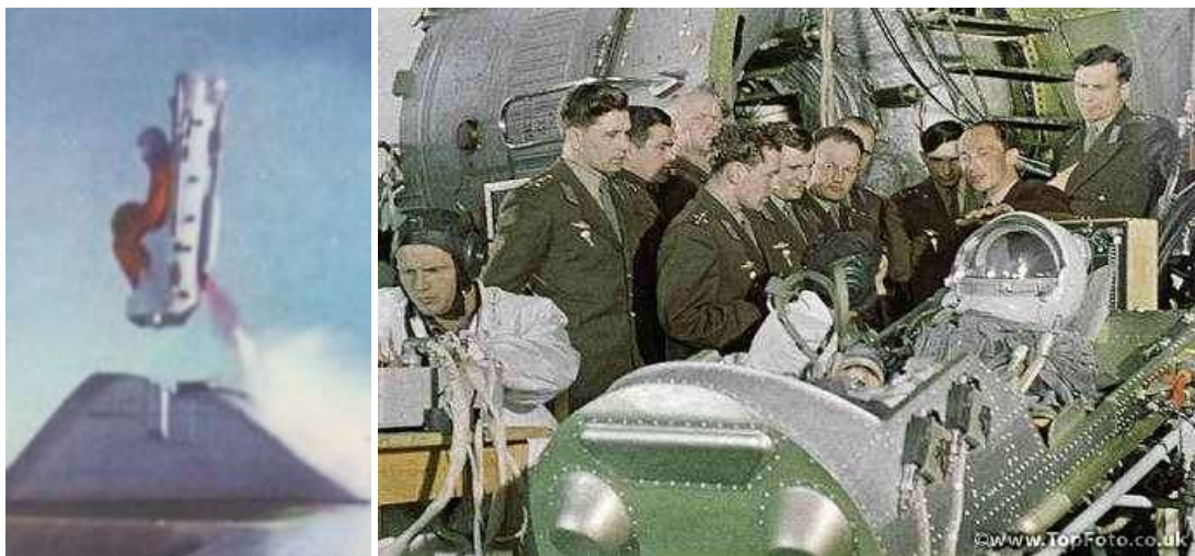
3. és 4. ábra. A Vosztok katapultülés gyakorlati tesztelése és bemutatása a későbbi utasainak (A kozmonauták csoportjában könnyen felismerhető a jövőbeni 1. és 2. számú űrhajósa.)
