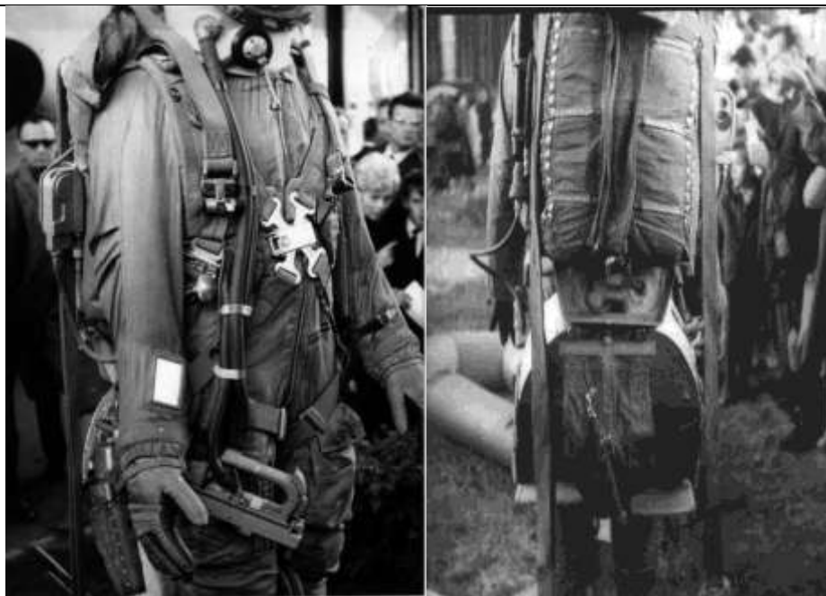
8. és 9. ábra. A Vosztok kozmonauták személyi ejtőernyői elől-és hátulnézetben (Az előlnézeti képen jól megfigyelhető a szovjet rendszerű pilóta mentő ejtőernyőkön elterjedt központi zár és a PPKU típusú ejtőernyő-nyitó félautomata, míg a hátulnézeti képen a kozmonauta ejtőernyője alá rögzített NAZ 10 készlet doboza)
