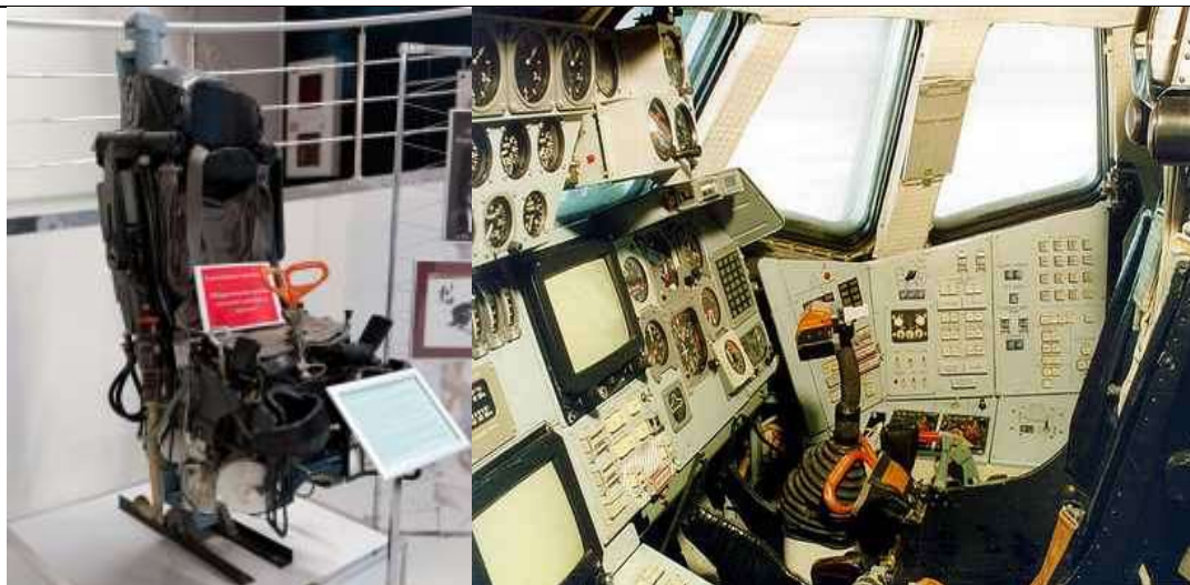
12. és 13. ábra. A K-36 típusú katapultülés Buran pilótafülkéjébe beépítésre tervezett módosított változata múzeumi kiállításon illetve a szovjet űrsiklóba beépítve
