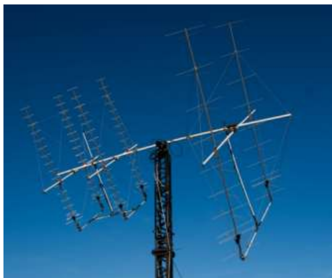
10. ábra Az elsődleges földi állomás antennarendszere
