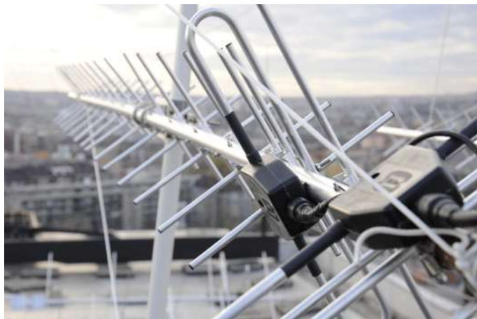
11. ábra 70 cm-es kereszt-Yagi antenna
