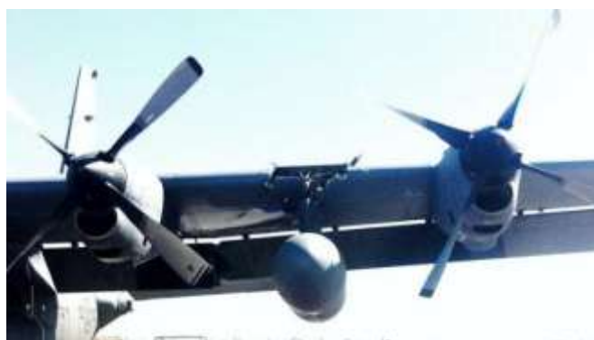
1. ábra Ütközés a levegőben: RQ-7 Shadow UAV által okoz sérülés egy C-130 Herculesen 4
