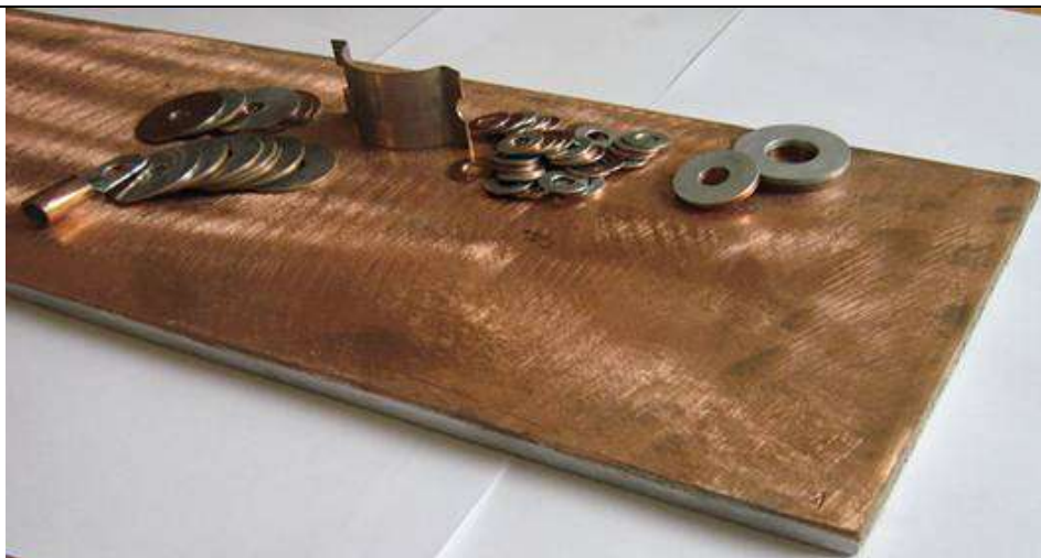
14. ábra Alumínium-réz plattírozott anyag és a belőle hengerelés után sajtolással készített alkatrészek
