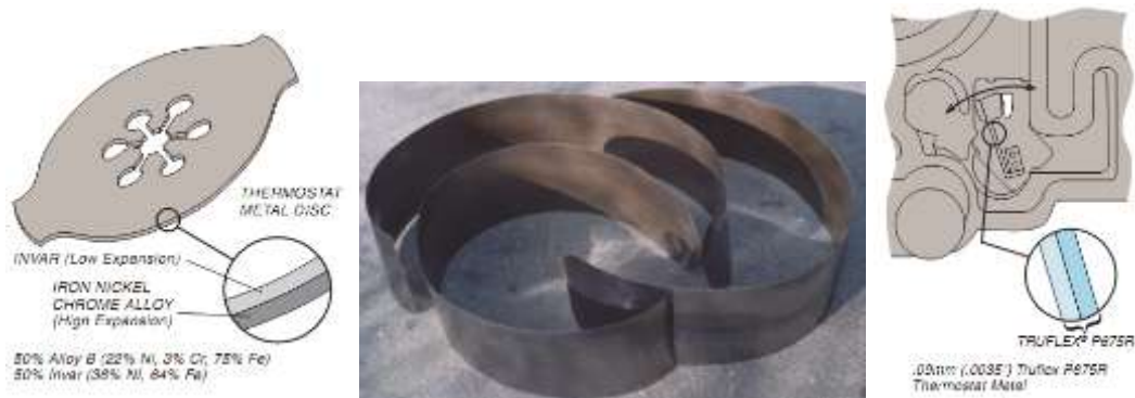
17. ábra A termobimetál repülőgépi alkalmazásai és a magyar invar-sárgaréz anyagminta
