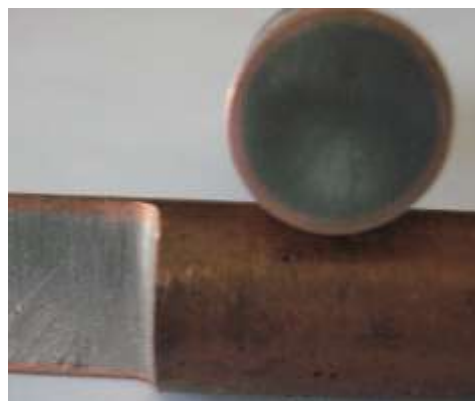
15. ábra A TI-Shield™ anyag működési elve és a magyar réz-acél anyagminta
