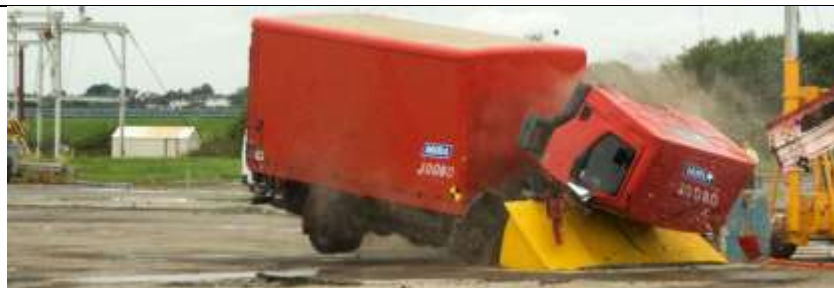
4. ábra. Hidraulikusan emelt útzár tesztelése 8
