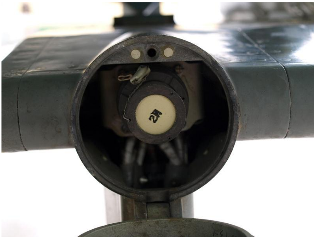
10. ábra A fedél alatti átkötéseket tartalmazó SR csatlakozó [10]
