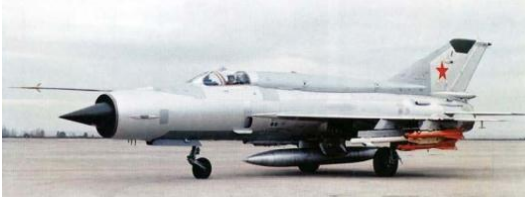
2. ábra MiG-21BISz 2 db R-3Sz és 4 db R-60-as légi harc rakétákkal felfegyverezve [4]
